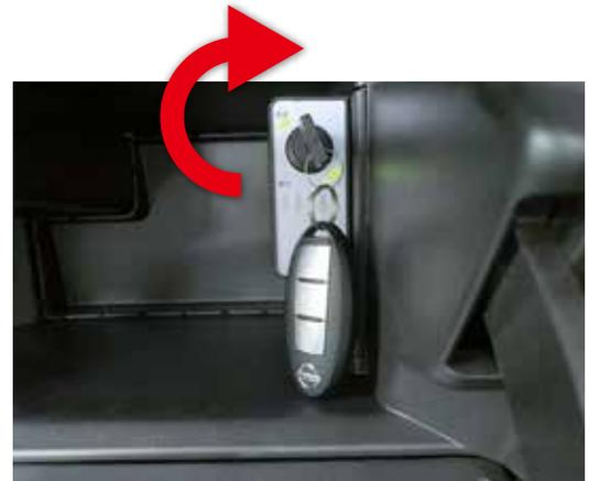
グローブボックス内のキーボックス挿入口にキーホルダーを挿入し、「貸出」から「返却」の位置へスイッチを回してください。車外に出てアプリより返却を完了してください。
